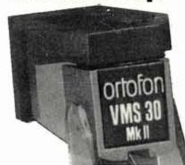
**ORTOFON VMS 30 MK II.** È il modello top della serie VMS, che è un brevetto originale Ortofon del complesso magnetico. Questo garantisce massa ridotta, alta separazione tra i canali, bassa distorsione, usura del solco ridottissima. La puntina è a taglio ellittico «Fine Line» ad eccezionale capacità di tracciamento; il corpo è di forma tradizionale.
