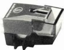
**AUDIOTECHNICA AT 120 E.** Testina di classe medio-economica, con stilo a taglio bi-radiale e cantilever in lega di alluminio; adotta un sistema di avvolgimento para-toroidale delle spire delle bobine, per ridurre al minimo il flusso disperso e aumentare la tensione di uscita. Uno schermo magnetico tra gli avvolgimenti migliora il dato di separazione tra i canali. *Risp. fr. 15 Hz/25 KHz; peso consigl. 1,4 g.*
