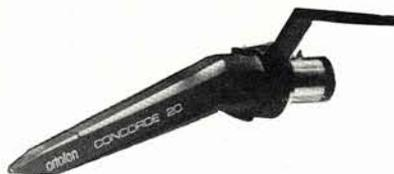
**ORTOFON CONCORDE 20.** Le caratteristiche meccaniche sono direttamente riconducibili alla STD, e cioè: corpo testina direttamente integrato con lo shell, attacco standard a norme internazionali, bassa massa complessiva. Lo stilo è a taglio «Fine Line» per un elevato contatto puntina-solco; la cedevolezza si attesta sui 20  $\mu\text{m}/\text{mN}$ , cioè adatta ad essere montati su bracci di bassa media. *Risp. fr. 20 Hz/20 KHz; peso lett. cons; 1,8 g.*
