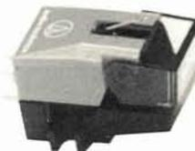
AUDIO TECHNICA AT 130 E. Valgono le stesse considerazioni fatte per il modello AT 120 E: sono comunque migliori i dati di risposta in frequenza (maggiormente estesa verso l'estremo alto della gamma), di separazione dei canali (30 dB a 1 KHz, valore eccezionalmente alto dovuto principalmente al sistema di due bobine separate con schermo magnetico interposto) e di peso di lettura (tracciamento permesso fino a 1 grammo date le ridotte masse in gioco). Lo stilo è anch'esso a taglio Bi-radial.
